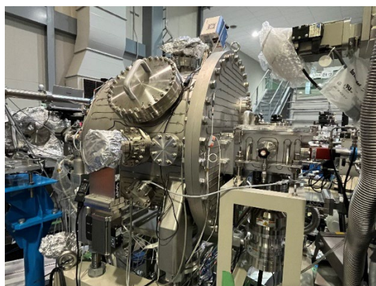
図 2. BL-9C 照射装置での照射スペクトルと、照射装置（H3 チャンバー）の写真。
