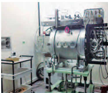
TPC を用いたガンマ線偏光計
