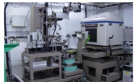
⑬大型 X 線回折計 (RI 実験棟実験ホール)
