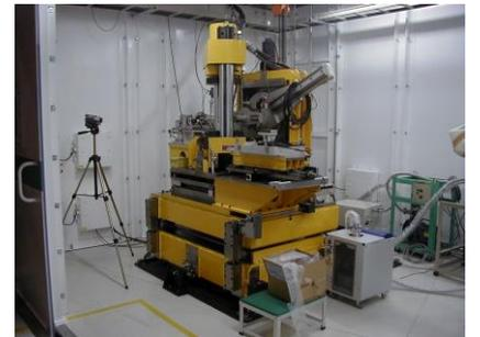
⑫ダイヤモンドアンビルセル (DAC) 回折計（蓄積リング棟実験ホール）
