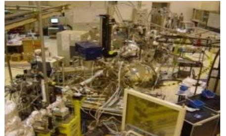
⑯軟 X 線磁気円二色性測定装置 (RI 実験棟実験ホール)
