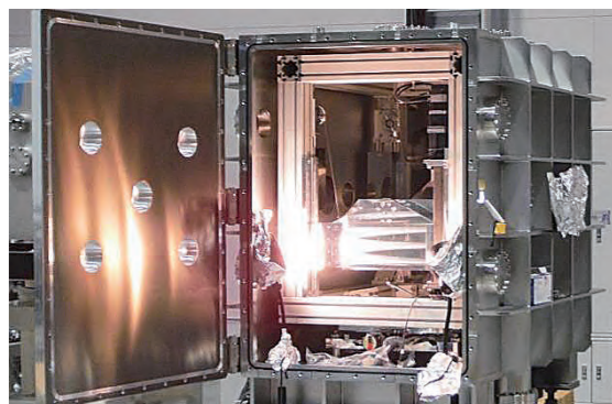
X線加工ステーション内部(6軸スキャンステージ)
