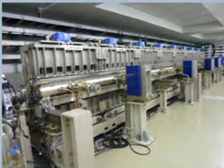
Long undulator 長尺アンジュレータ(10.8m)
