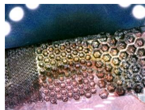
図 3. 実験結果 (FEP 厚さ 左図: 100\mu\text{m} 右図: 500\mu\text{m} )
