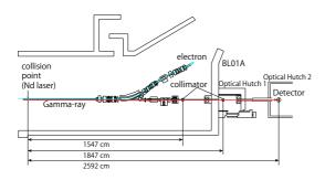
Fig. 5 シミュレーションでの配置
