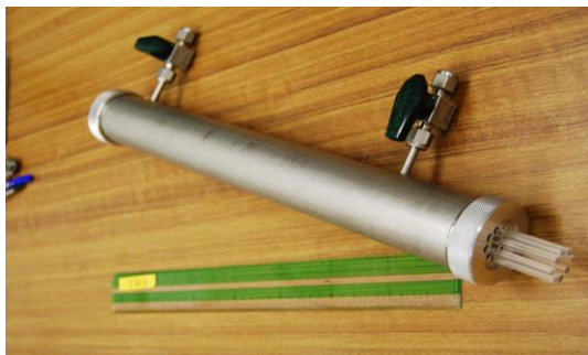
図1 ^{20}\text{Ne} ターゲットセル。ガンマ線ビームは図中の矢印でしめすようにセル中に入射する。セル内には 1 \times 10 \times 300 mm厚の薄いプラスチックシンチレータがビームと平行に設置されていて、ガンマ線により光励起された ^{20}\text{Ne} から放出される荷電粒子を検出する。荷電粒子がシンチレータに入射して生じたシンチレーション光はターゲットセルの上流と下流に設けたアクリルのライトガイドによりセル外に導かれ多チャンネル型の光電子増倍管により電気的信号に変換される。
