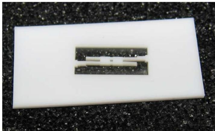
図2 放射光直接エッチングにより得られたテフロン導波管パターン
